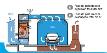
P Funcionamento - O funcionamento com fluxo de ar vertical (downdraft) utilizado na Cabine Millibar, assegura as melhores condições para as operações de pintura. Um teto totalmente filtrante e uma saída de ar sob grades do piso, asseguram um fluxo vertical descendente, uniformemente distribuído ao interior da Cabine que faz a remoção imediata do over spray de tintas e vernizes em todos os pontos ao redor do veículo.
