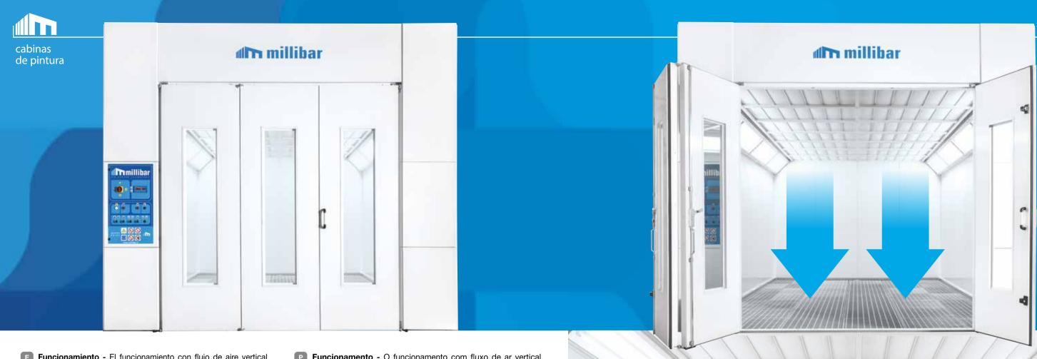
**Funcionamiento** - El funcionamiento con flujo de aire vertical (downdraft) utilizado en la cabina Millibar asegura las mejores condiciones para las operaciones de pintado. Un techo totalmente filtrante y una fosa de salida de aire garantiza un flujo de aire vertical descendente, uniformemente distribuido en el interior de la cabina que permite eliminar de manera inmediata el overspray de pintura en todos los puntos alrededor del vehiculo.
